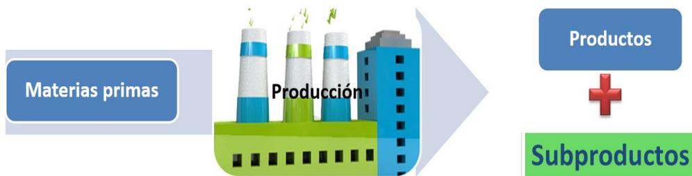
Subproducto del Proceso. Ejemplo: Producción Biodiesel, 1 tonelada de Aceite RBD de palma + metanol + catalizador con reacción de trans-esterificación se obtiene 90% de BIO DIESEL (Producto) y un 10% de GLICERINA (Subproducto).
